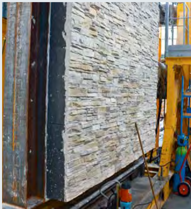
murogeopietra su Fassatherm® EPS sp. 200 mm
