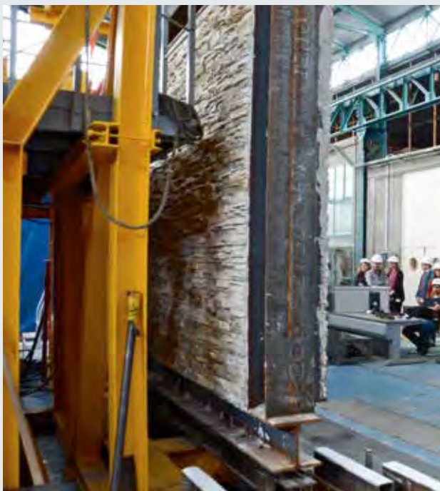
murogeopietra su blocchetti di cemento
